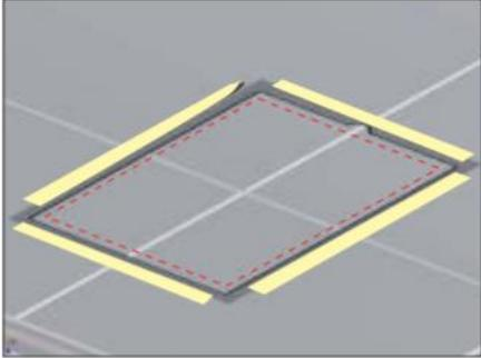
2. Colocar la plantilla con cinta adhesiva en la ubicación donde se instalará la rejilla y perforar el área marcada.
